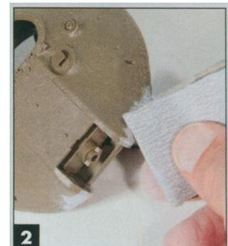
Leichtes Schmirgeln verfeinert die Tex-turen und gleicht sie den gegossenen Oberflächeneinzelheiten des Modells an.
