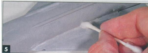
... das Wattestäbchen entlang des Spaltes führen. Der Alkohol weicht Mr. Surfacer leicht auf und beim Reiben wird überschüssiges Mr. Surfacer entfernt. Diese Methode ist besonders hilfreich dort, wo man schlecht schmirgeln kann oder nicht schmirgeln will.
