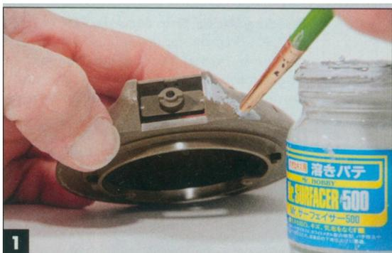
Viele Panzer haben eine rauh-gegossenen Panzerung am Turm oder an der Wanne, die am Modell nicht dargestellt ist oder beim Bauen beschädigt wurde. Mit einem alten Pinsel, dessen Borsten sehr kurz geschnitten wurden, wird Mr.Surfacer in dem gewünschten Bereich aufgetragen. Als es zu trocknen beginnt, mit dem Pinsel betupfen.
