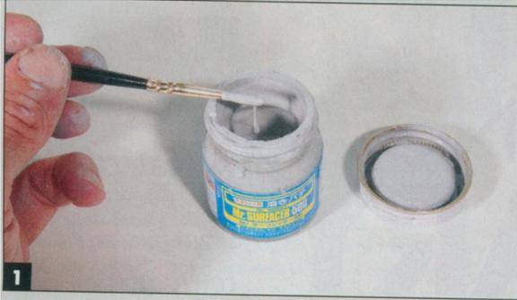
Direkt aus der Flasche ist Mr. Surfacer dickflüssig, ideal zum Füllen kleiner Löcher und Spalte
