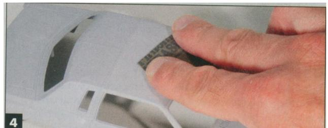
Eine zweite Schicht Mr. Surfacer verdeckt Schmirgelfehler. Gunze empfiehlt die Oberfläche mit 1000 er Nass/Trockenschleifpapier vor der Bemalung des Modells zu schleifen
