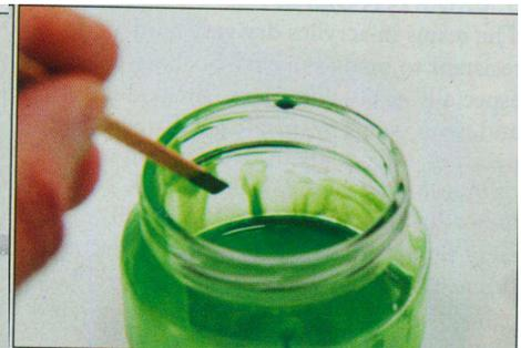
Der Fließtest ist eine gute Maßnahme, um die richtige Konsistenz zum Spritzen zu ermitteln. Wenn ein Farbtropfen gleichmäßig abläuft und einen gleichmäßigen Farbfilm hinterlässt, ist sie richtig (links). Wenn er nicht läuft (mitte), ist sie zu dick, und wenn er schnell läuft und einen ungleichmäßigen Farbfilm hinterlässt, ist sie zu dünn.
