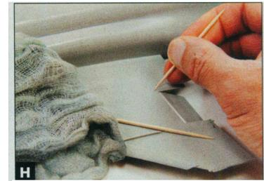
**H** Staub ist der Feind guter Farbe. Mit einem Zahnstocher durch die Blechstöße gehen, ein „tack-cloth“ entfernt den Rest
